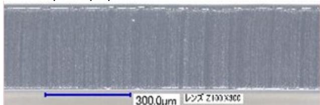
La pointe du tranchant à 50/60° lui permet d’absorber la pression sans blanchir le filet.
